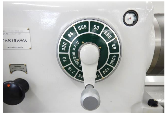
主軸速度変換レバー (最高回転速度1500min -1 )
